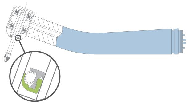
Bal Seal<sup>®</sup> KTS Series Seal
